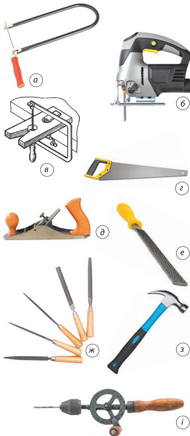
Мал. 9.2. Інструменти для обробки деревинних матеріалів: а — лобзик ручний; б — лобзик електричний; в — підставка для випилювання та кріплення; г — ножівка; д — рубанок; е — рашпиль; ж — надфілі; з — молоток; і — дриль ручний
