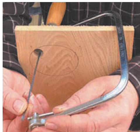
Мал. 9.9. Закріплення пилочки для випилювання внутрішнього контура
