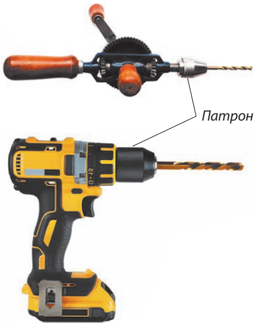
Мал. 9.10. Закріплення свердла в патроні
