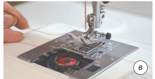
Мал. 10.23. Заправлення нижньої нитки в машину з горизонтальним човниковим механізмом
