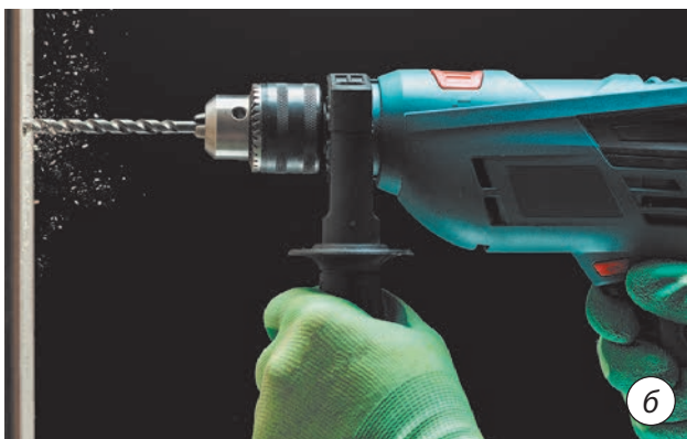
Мал. 9.12. Положення дреля під час свердління
