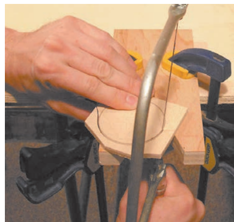
Мал. 9.8. Випилювання по зовнішньому контуру
