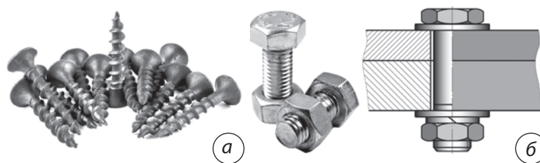
Мал. 8.2. Рознімне з'єднання: а — шурупове; б — болтове
