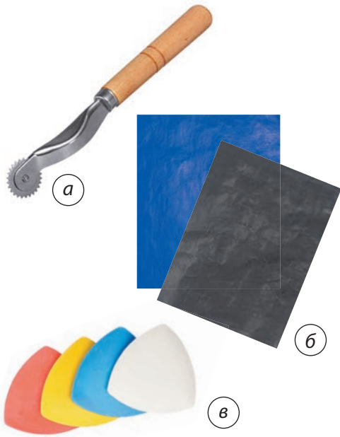
Мал. 10.4. Маркувальні матеріали: a — різець; б — копіювальний папір; в — кравецька крейда
