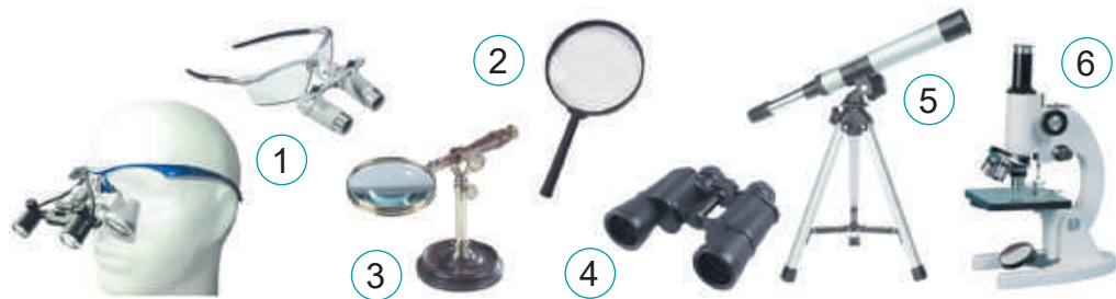
Мал. 20. Збільшувальні прилади: 1 – бінокулярна лупа; 2 – лупа; 3 – штативна лупа; 4 – бінокль; 5 – шкільний телескоп; 6 – мікроскоп
